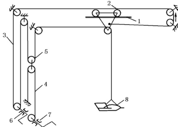
图4.1.4-1 开口式游轮缆道基本型式示意图
