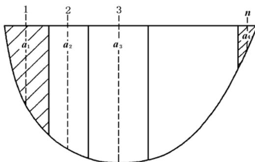
图 6.4.3 断面取样垂线权重划分示意图
