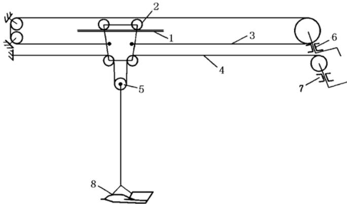
图4.1.4-2 闭口式游轮缆道基本型式示意图
